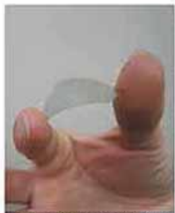
●シート上に作製された水素ガスセンサー アモルファスの酸化タンゲステン薄膜は室温で作製できるため、さまざまな基板上に薄膜を作製できる。
